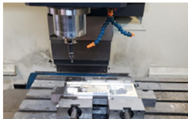
En la Figura 3, se puede observar que se realizaron las cavidades pertinentes para que pudieran calzar con exactitud los mecanismos de la Figura 2, así como también la cavidad en la parte posterior del cuerpo para el acoplamiento de la culata.
