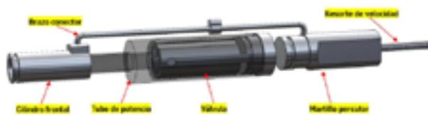
Una vez hecho este levantamiento en software CAD, se planteó un modelo base del cuerpo en impresión 3D, en el cual se encajaron los componentes para dar paso a la fabricación del arma no-lethal en aleación de Al 7075- T6.
