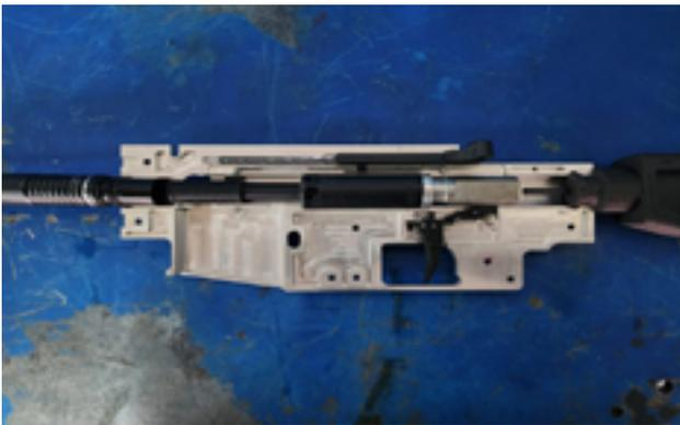
Después, se realizaron varias operaciones de acabado, como esmerilado y redondeo, para eliminar las aristas vivas y principalmente para hacer posible el mecanizado del arma no-letal. Así se pudo obtener el cuerpo mecanizada en el torno CNC. Finalmente, una vez mecanizado el cuerpo del arma no-letal, se procedió a unir las dos piezas que conforman el cuerpo y, con la ayuda de un machuelo, se procedió a realizar la rosca métrica ISO 22 X1.5; véase la Figura 5.
